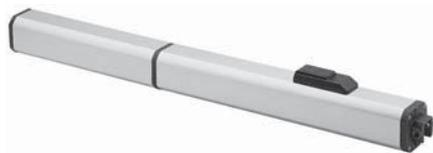
Электрогидравлический привод распашных ворот, для 1-створчатых и 2-створчатых распашных ворот высотой макс. 2500 мм, с шириной створки макс. 7000 мм и весом створки макс. 1000 кг. Требуется электрозамок и концевые упоры.
